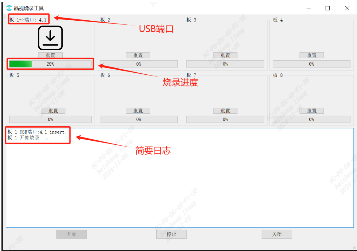
图 3.12: 插入 USB 设备开始烧录
