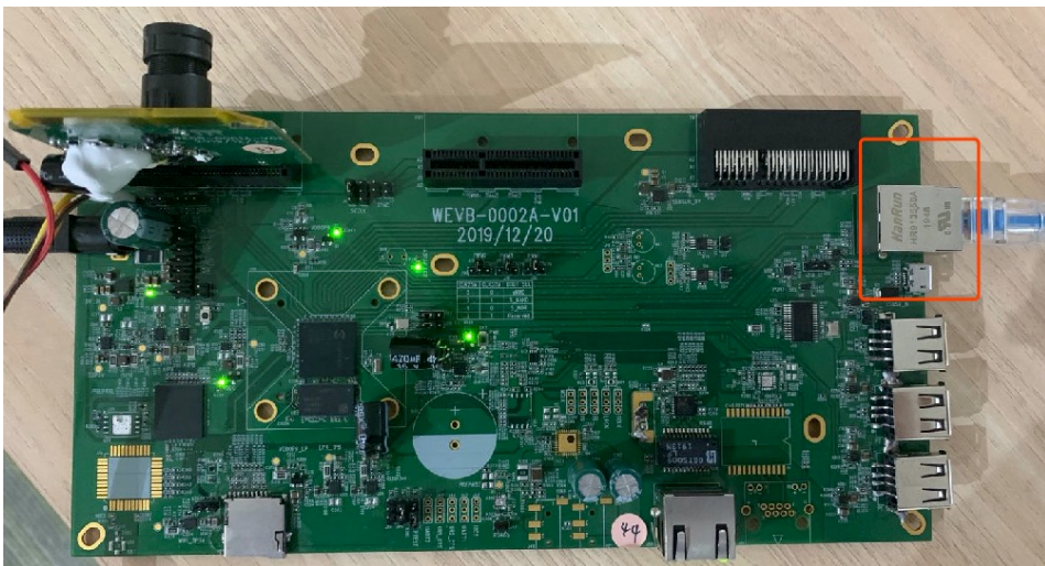
图 3.22: 网口连接示意图
