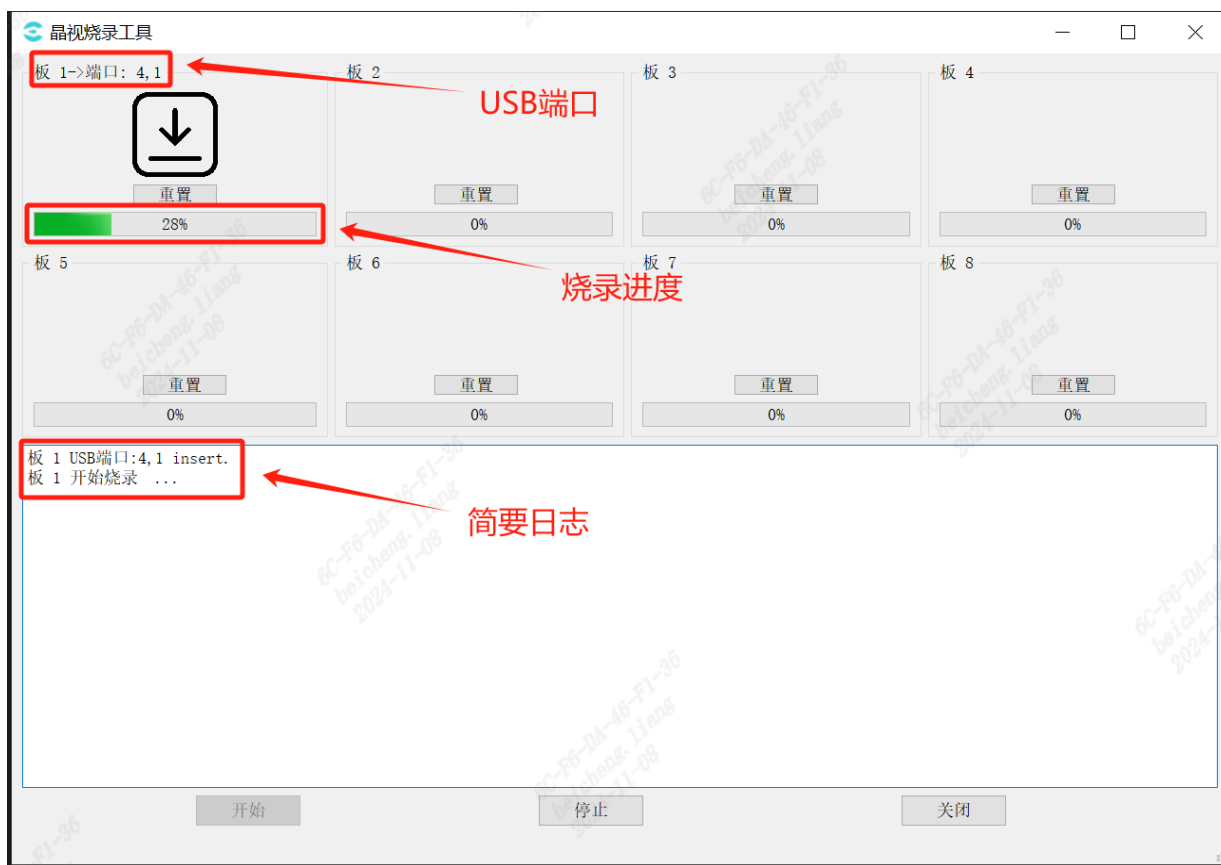
图 3.12: 插入 USB 设备开始烧录
